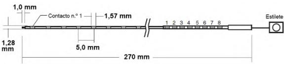
**Figura 2 – Electrodo de profundidad de haz de alambre**
