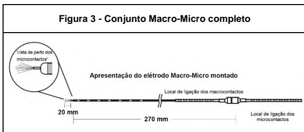
Nota n.º 3: Os microfios prolongam-se 20 mm para além da ponta; corte até ao comprimento pretendido antes de utilizar.
