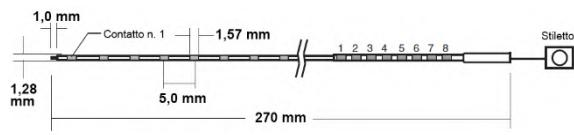
**Figura 2 – Elettrodo di profondità Wire Bundle**
