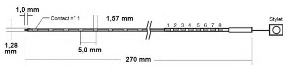
Figure 2 – Électrode de profondeur à faisceau de fils
