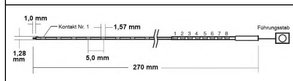
Abbildung 2 – Drahtbündel-Tiefenelektrode
