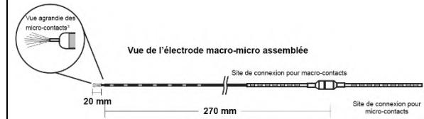
Remarque n° 3 : Les micro-fils dépassent de 20 mm de l'extrémité ; les couper à la longueur souhaitée avant utilisation.
