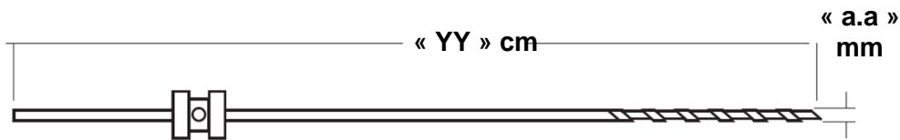
Figure 2 – Utilisation du foret crânien et de la butée de profondeur
